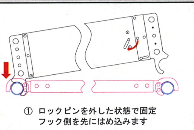
① ロックピンを外した状態で固定フック側を先にはめ込みます
