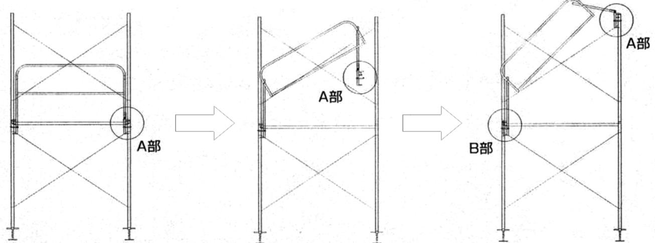
※必ず確実に止め具をロックしてください。
