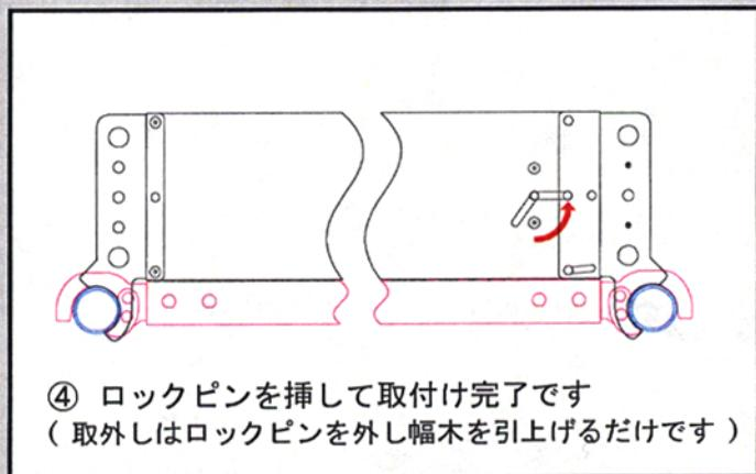
④ ロックピンを挿して取付け完了です
