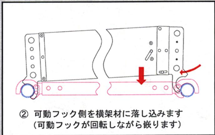
② 可動フック側を横架材に落し込みます
